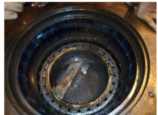
b) Effet d'une mauvaise lubrification
