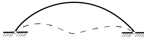
Affaissement de l'arc dans son plan « Snap-Through »
